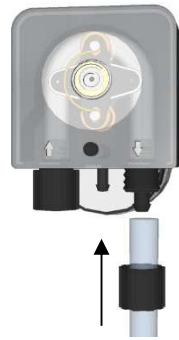
Etape 13 Même opération du côté de la pompe doseuse.
